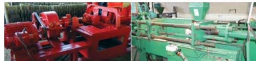
Asimismo, el proyecto propició la reparación y puesta en marcha de 28 equipos, lo que ha posibilitado el incremento de la capacidad productiva. Resaltan dentro de esta recuperación 3 extrusoras para el procesamiento del barro en los tejares, destinado a la producción de ladrillos, tejas, etc. El rescate de estos equipos se realizó gracias a la intervención de reconocidos innovadores del territorio quienes desde cooperativas de reciente creación dieron el servicio.
