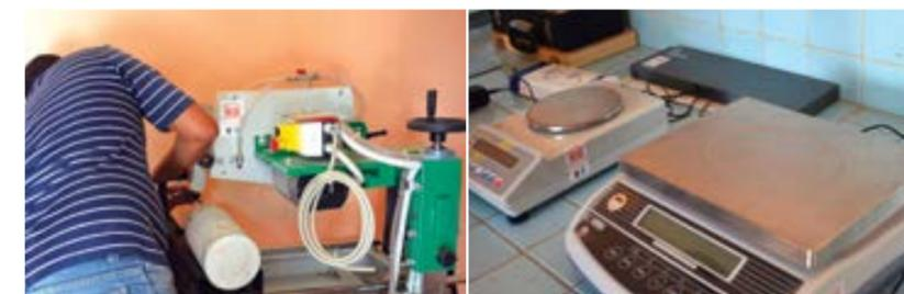
Otro aspecto a destacar es que el proyecto revitalizó el laboratorio de control de la calidad de materiales de construcción de EPROMAC. Se entregaron más de 12 equipos e insumos de laboratorio, que posibilitan el control de calidad de las líneas de hormigón y cerámica. Esta es una contribución clave del proyecto dada la necesidad que existe en Santiago de controlar la resistencia de los materiales ante el riesgo sísmico y de huracanes.
